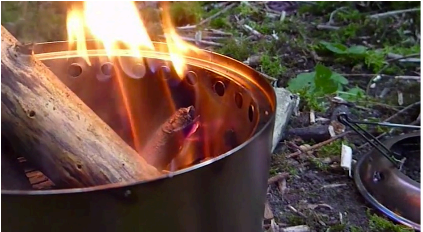
Apport d'air chauffé par la double parois
