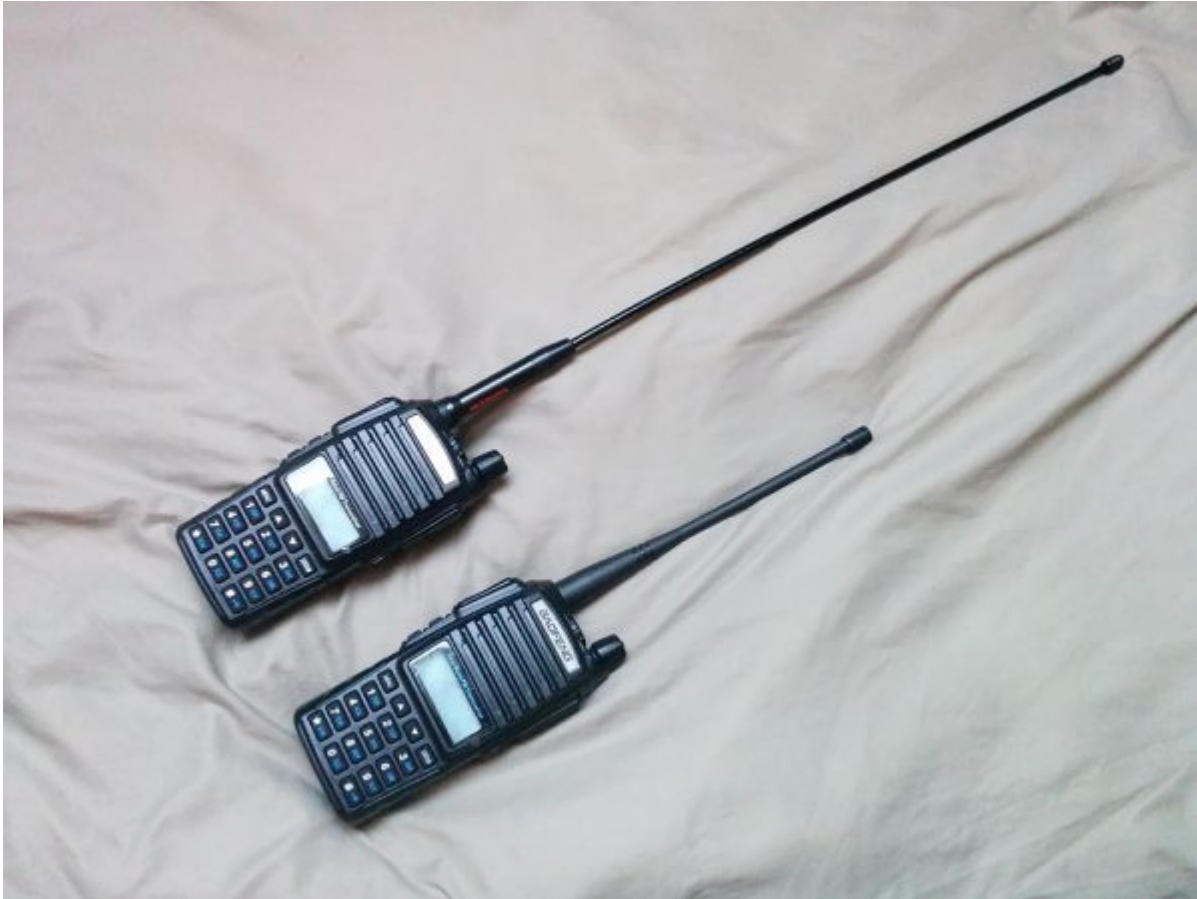
Antenne d'origine et Antenne Diamond
