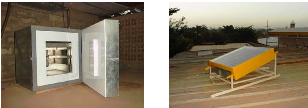
Figure 9 : Prototype construit par le CEAS – Ouagadougou – Le capteur solaire se trouve sur le toit de l'atelier alors que l'enceinte frigorifique est à l'intérieur
