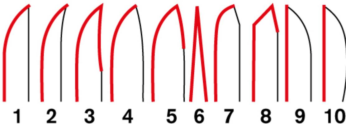
1- probablement le type de lame le plus courant. Une lame normale, à **dos plat**, pouvant servir pour couper ou transpercer.
